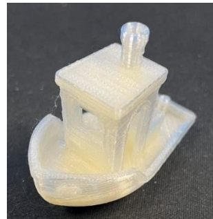
Figur 67: Dokumentasjon av figur med rPLA
