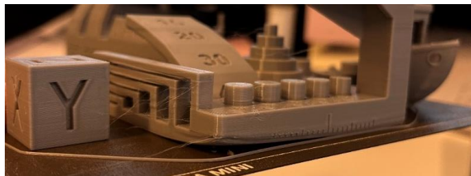
Figur 45: Dokumentasjon på at test har løsnet fra platen
