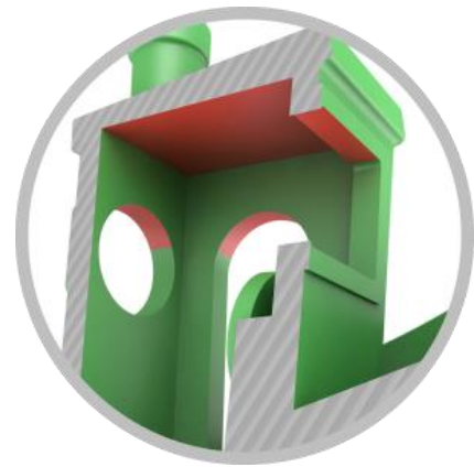
Figur 35: Testing av overheng med Benchy
